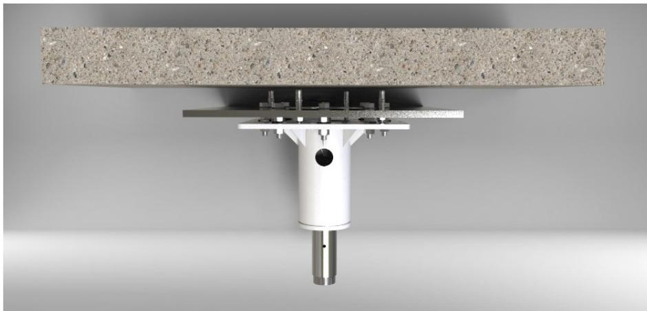
Com os chumbadores (04 parabolts 3/8" x 3.3/4") instalados no teto, posicione o disco de fixação no teto, prendendo-o utilizando-se das porcas de fixação (04 porcas). Com auxílio de uma chave de boca aperte as porcas até que o disco esteja totalmente fixado no teto.
